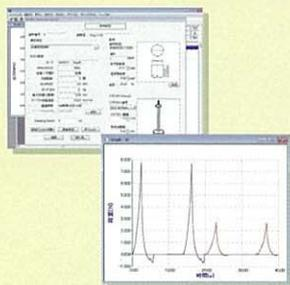
レオメーター専用ソフトを使用することで、テクスチャープロファイル、クリープ、積分値などの計算が瞬時に行え、グラフの重ね、平均化、統計処理と、物性データが効率よく解析でき、本体での数値だけでは解析しきれない、食感や微妙な物性の違いを特定することができます。
